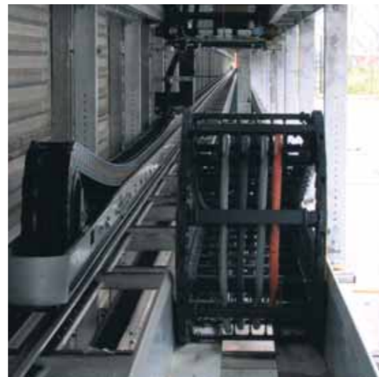
长行程用拖链/电缆试验台：在130米行程上以8米/秒的速度进行试验。
