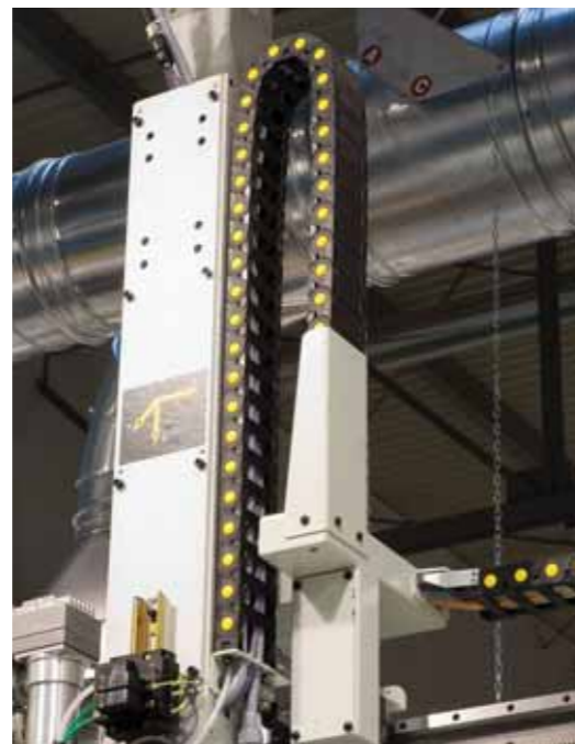
机床上的垂直应用尼龙拖链
