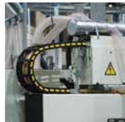
装有尼龙电缆拖链的机床
